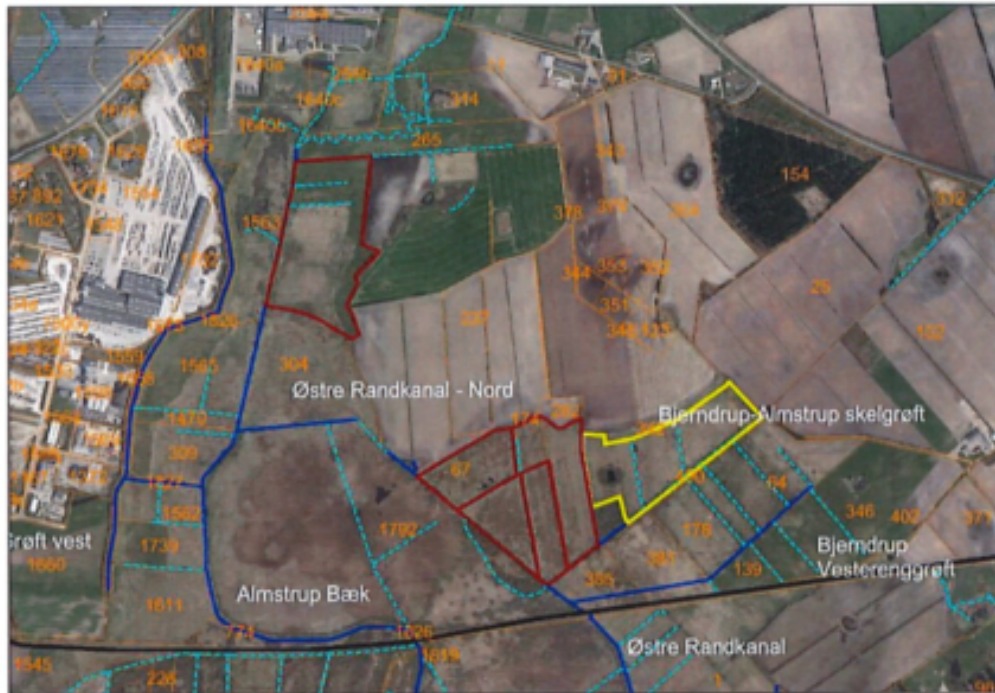
Figur 1: Afgrænsning af Område 1 (gul streg) og Område 2 (brun streg) for en nærmere hydrologisk analyse. Orange streg angiver matrikler (med nummer). Desuden er angivet vandløb (blå streg) og grøfter (stiplet blå streg). Jernbane vist med stort streg.
